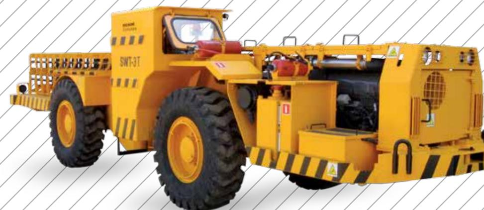
Другие самоходные транспортные машины позволяют перевозить элементы с возможностью механической разгрузки с помощью механического крана. Кроме того, под защитным козырьком с регулируемой высотой расположены сиденья для перевозки ремонтной бригады. На платформе находится слесарный верстак с тисками. Установленный на тягаче сварной агрегат с гидравлическим приводом позволяет выполнять сварочные рабо-
